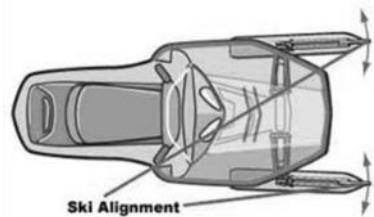
\*\*\* Ajuster vos skis (de gauche à droite) pour aligner les skis à 0 degrés d'ouverture. Les skis doivent être absolument PARALÈLES. Les mesures entre vos skis en arrière et celle d'en avant doivent être identiques. \*\*\*
